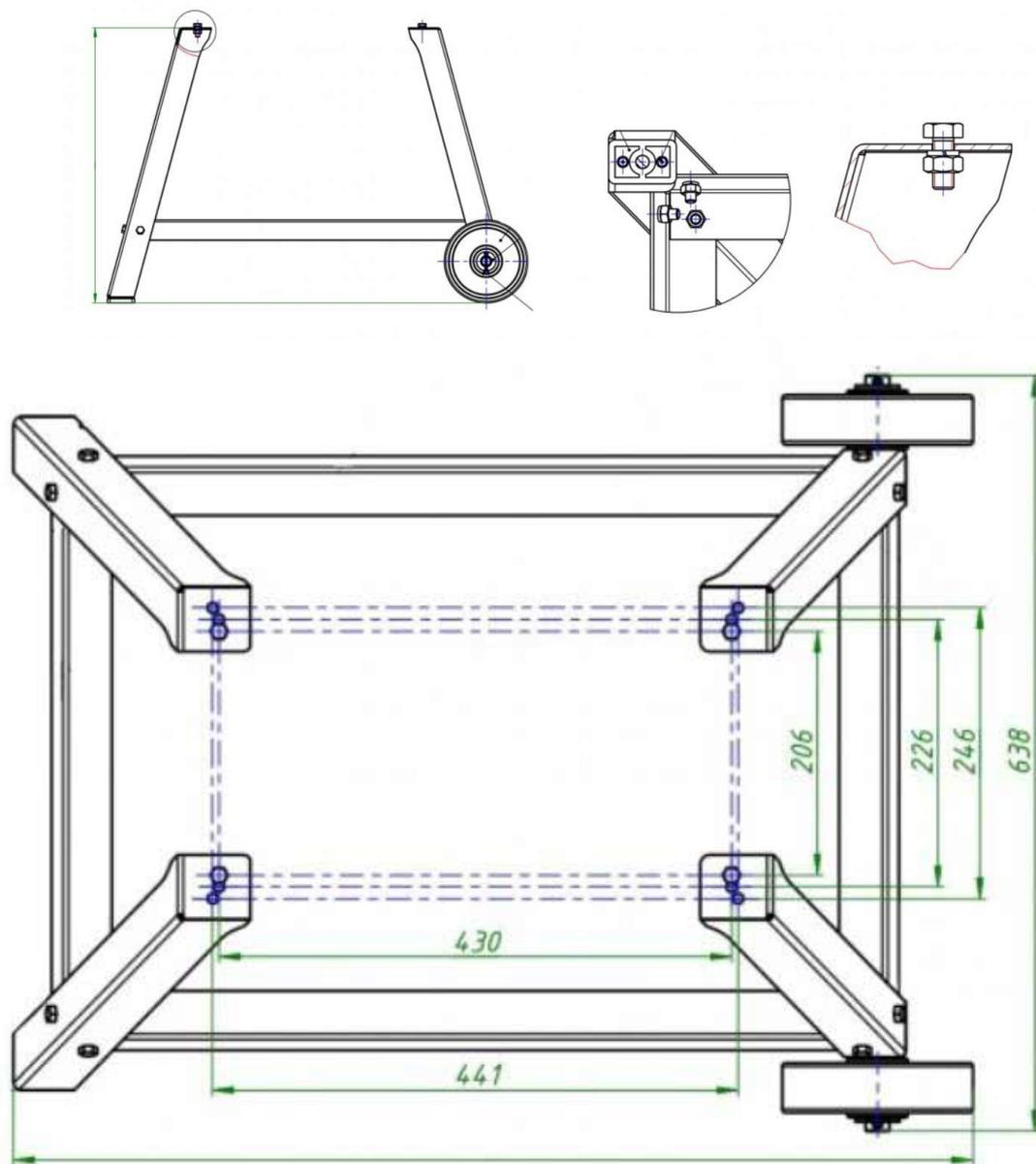
Récapitulatif des caractéristiques techniques Référence : BEPK1 Hauteur de travail support + machine : 930 mm Dimensions : 805 x 638 x 530 mm Poids Net / Brut : 9,2 Kg / 10 Kg Colisage : 905 x 197 x 111 mm
