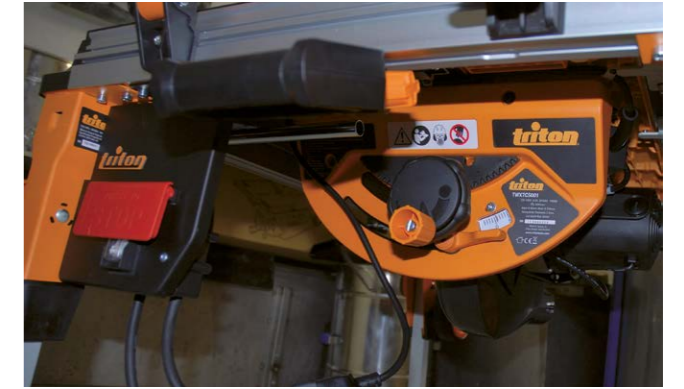
Vue du dessous du bloc-machine. Rien que de très classique : un volant pour la montée et la descente de la lame ; le même volant une fois poussé permet le pivotement du bloc-moteur vers la gauche pour les coupes angulaires.
