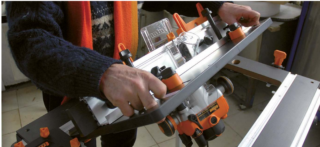
Mise en place du module de défonçage : aussi facile et rapide que le module de sciage.
