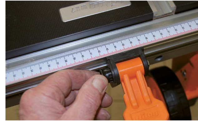
Pour un parfait blocage de la règle, le fabricant a prévu un réglage de la pression de l'excentrique.
