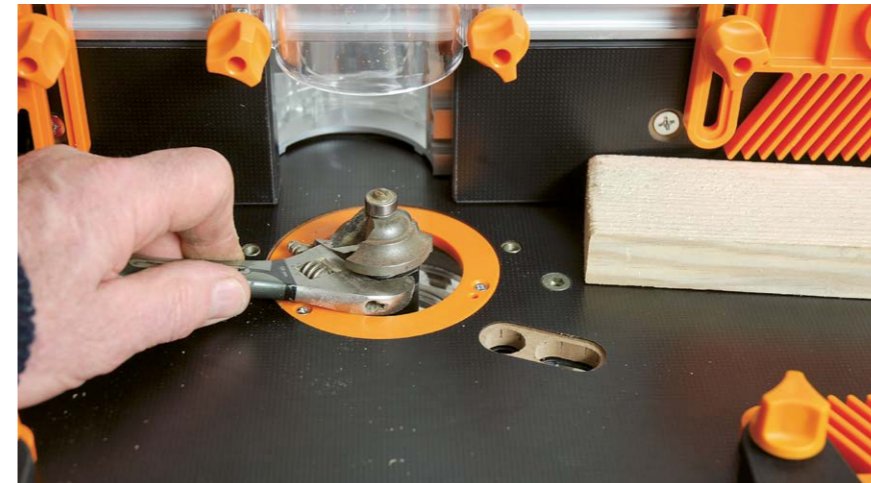
Le montage de la fraise (queue de 8 ou 12 mm) se fait très facilement, la pince pouvant être remontée très haut et se bloquant automatiquement.
