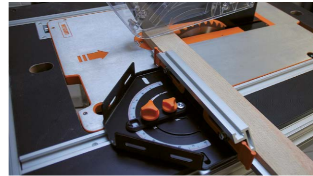
Dispositif pour les coupes perpendiculaires et angulaires. Une butée permet un réglage automatique pour les coupes à 90°. Pour les coupes d'angles, il faudra faire pivoter la tête jusqu'à l'angle souhaité et l'y bloquer. Pour les coupes d'onglet à 45°, on se contentera de positionner le bois à l'arrière de la tête.
