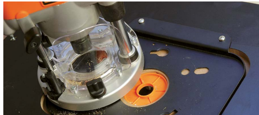
Pour la fixation de la défonceuse, Triton a prévu une semelle en acier fixée sous la table. Avec les modèles de sa marque (défonceuses Triton TRA 001, Triton MOF 001 et Triton JOF 001), la fixation est instantanée sans réglage. Pour les autres marques de défonceuses, il faudra certainement procéder à quelques adaptations.
