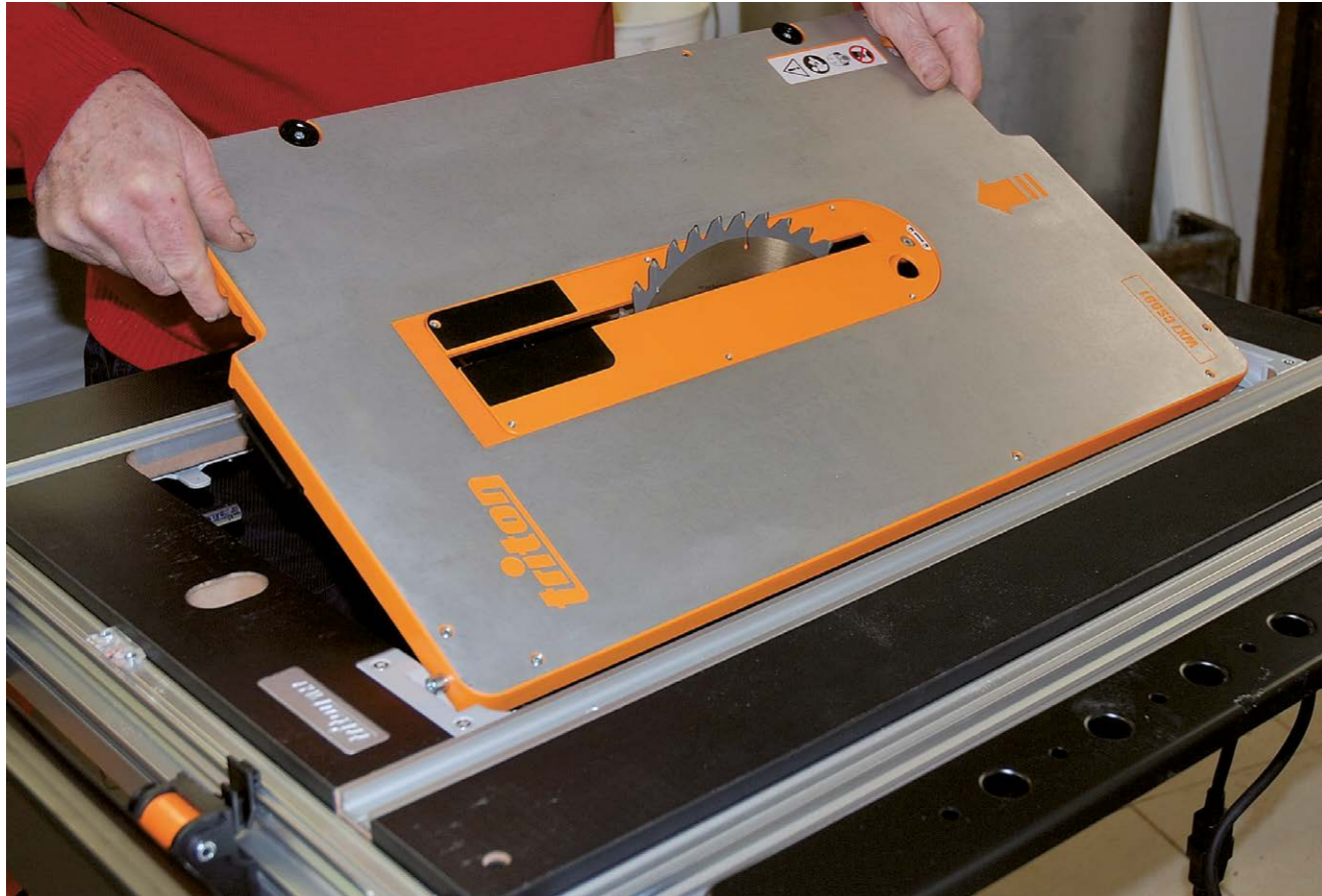
Pour le montage du module de sciage dans la table Triton TWX7 Workcentre, rien de plus simple : il suffit de démonter la table d'origine en médium (après avoir déverrouillé les deux blocages latéraux) et de glisser en même place le module de sciage.
