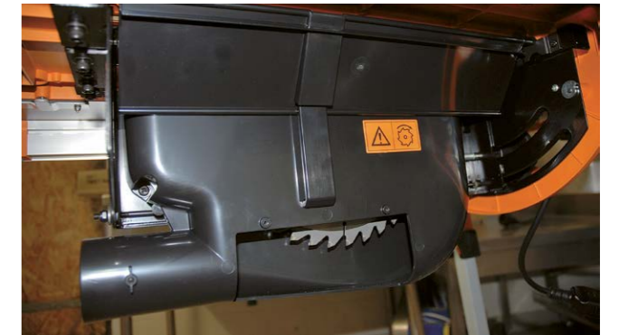
Sous la machine, vous remarquerez la buse pour le branchement du tuyau d'aspiration et la trappe (ouverte) pour la récupération des chutes de bois malencontreusement tombées dans le capot.
