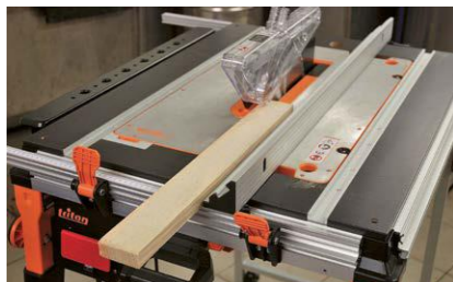
Machine et guides réglés pour une coupe longitudinale.
