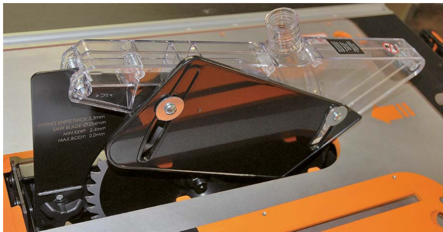
Une fois le module de sciage installé, vous devrez en premier lieu retirer la plaque d'obturation et monter sur la machine le bloc « couteau diviseur/cape de protection/buse d'aspiration des sciures ». Pour ce faire, nul besoin de clé, un bouton moleté fixé à demeure au point de fixation du couteau diviseur permet de maintenir l'ensemble.
