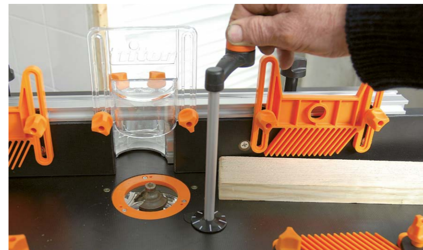
Un levier à glisser dans un trou réservé dans la table permet un ajustement précis de la hauteur de réglage sans avoir à se coucher sous la table.
