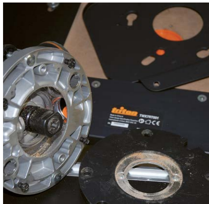
Avant la fixation de la défonceuse sous la table, il faudra démonter sa semelle de glissement en plastique.
