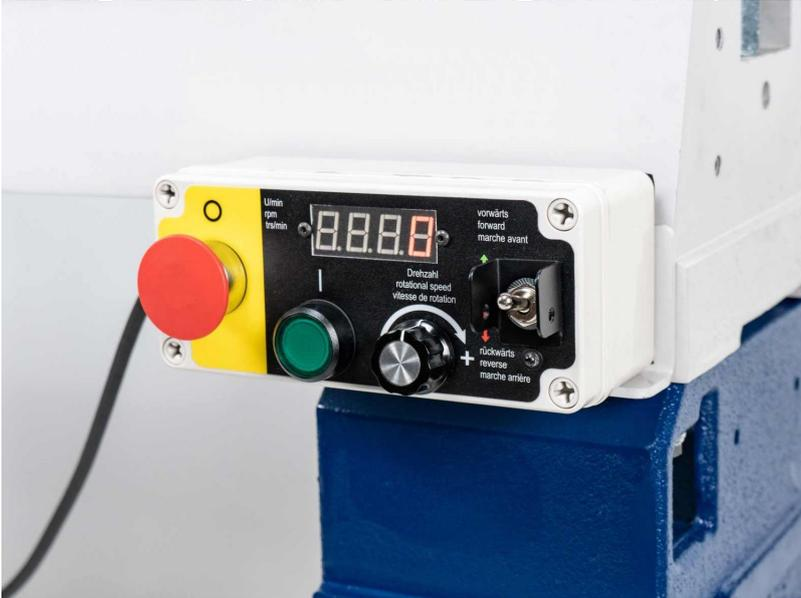
Interrupteur principal, interrupteur de freinage
