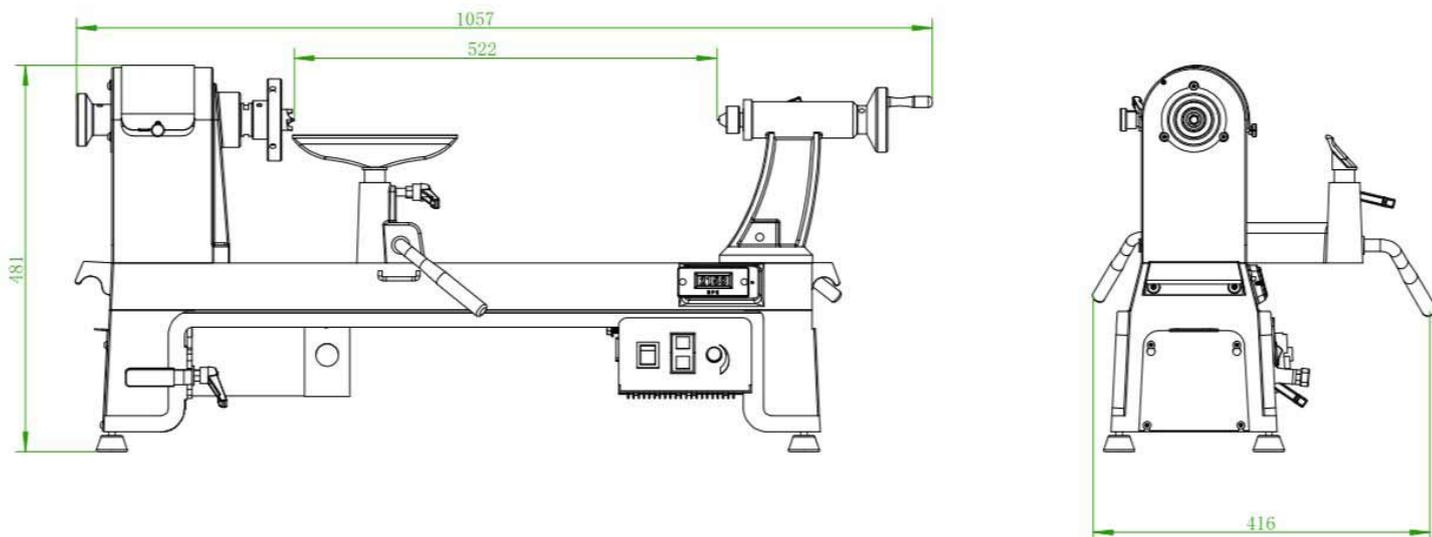
Tableau des caractéristiques techniques : Entre pointes 510 mm Diamètre maxi de tournage 355 mm
