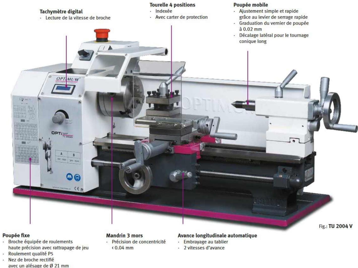
Accessoires fournis avec le tour : 1 x mandrin 3 mors diamètre 100 mm 1 x pointe fixe CM2 1 x pointe fixe CM3 Carter arrière Carter de mandrin asservi Bac à copeaux Tourelle 4 positions Pignons de filetage en acier Clés de service et manuel
